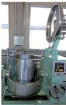
↑レオニーダー（蒸気加熱機）
