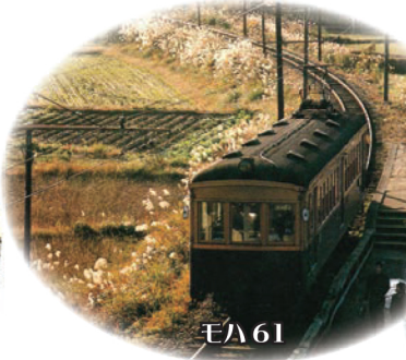
モハ61 昭和15年製造 珍しい半鋼鉄製車
